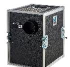
Verdampfer-Nebelmaschine Leistung 1300 W Fluidverbrauch bei max. Aussto 120 ml/min bei Dauernebel 35ml/min Fluidbehälter 5 l Nebelaussto in 99 Schritten einstellbar, 1-Schritte Nebelzeit bei 100 Aussto ca. 40 s, bei unter 50 Aussto Dauernebel Ansteuerung DMX 512, 0-10 V Timer Stand-alone-Betrieb Aufheizzeit ca. 7 min Temperaturregelung mikroprozessorgesteuert berhitzungsschutz Heizblock im Thermostat, Pumpe mit Temperaturschalter Abmessungen L x B x H 47 x 23 x 24 cm Gewicht ohne Fluid 9 kg
