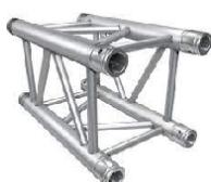
Aluminiumtraverse mit 0,5m LängeRohrdurchmesser 50 mmWandstärke 2 mminkl. einem Konusverbindersatz und R-Clips
